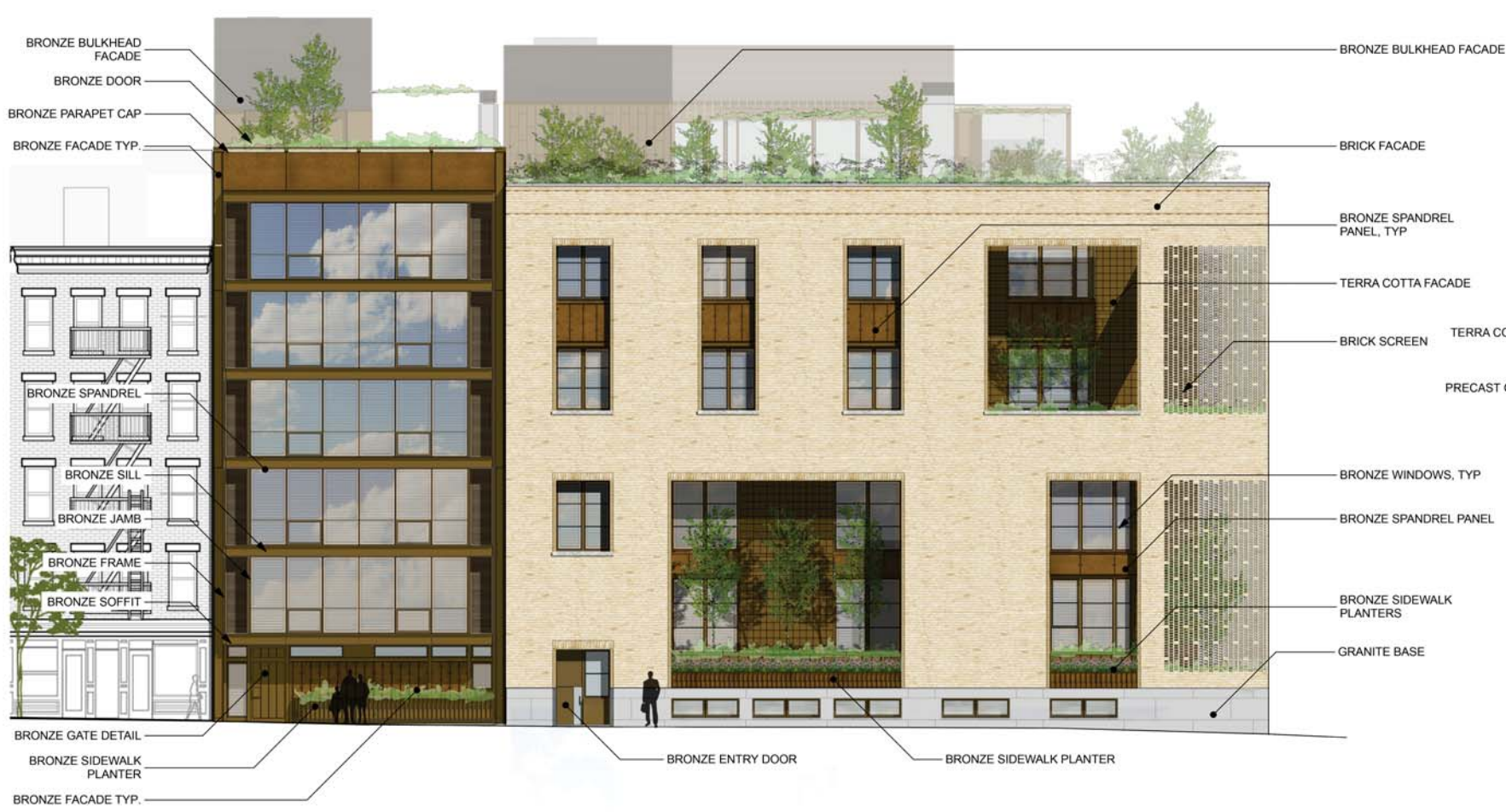
WEST ELEVATION (WASHINGTON STREET) SCALE: 1/8" = 1'-0"
